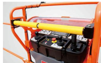
Dispositif anti extrusion
