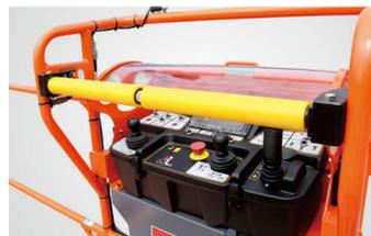
Dispositif anti extrusion
