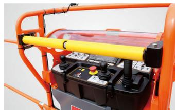
Dispositif anti extrusion
