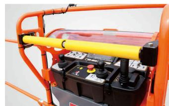
Dispositif anti extrusion
