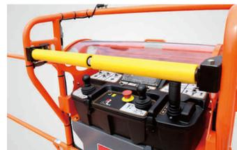
Dispositif anti extrusion
