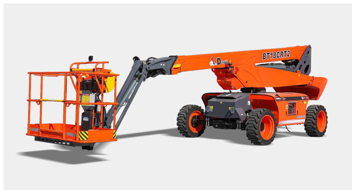
Flèche télescopique travail maximum-18m
